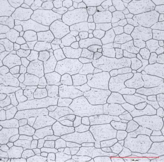
(a) Sürekli Tavlınmış CQ Kalite LOM (x500)
