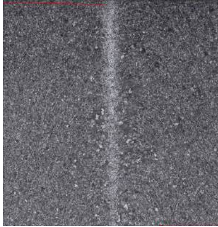
ERW kaynak sonrası tavllanmış mikroyapı
