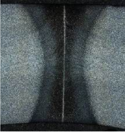
ERW kaynak sonrası mikroyapı
